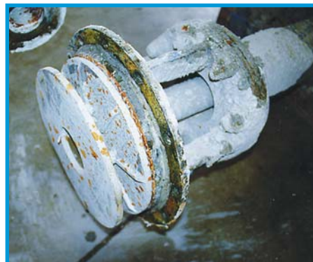
Después de siete años manejando abrasivos, este Discpac no ensena un desgaste apreciable.
